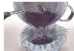
• **Continua:** el disolvente utilizado para la extracción se hace pasar por la droga, arrastrando a los principios activos de un paso. Este proceso permite extraer casi por completo, los compuestos químicos presentes en la droga.
