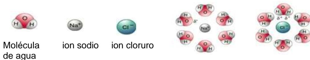
Solvatación del cloruro de sodio en disolución acuosa
