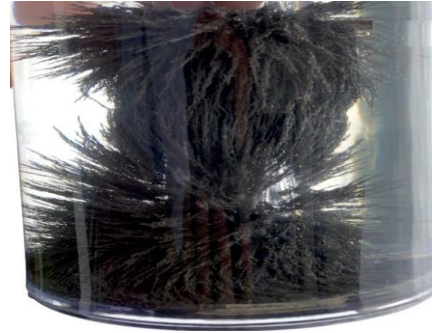
Figura 23. Limaduras de hierro atraídas por un imán de barra. Se observa que el campo magnético rodea al imán.
