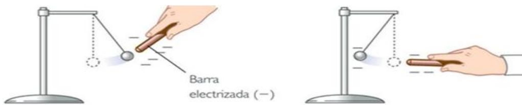
Figura 3. Electrificación por contacto
