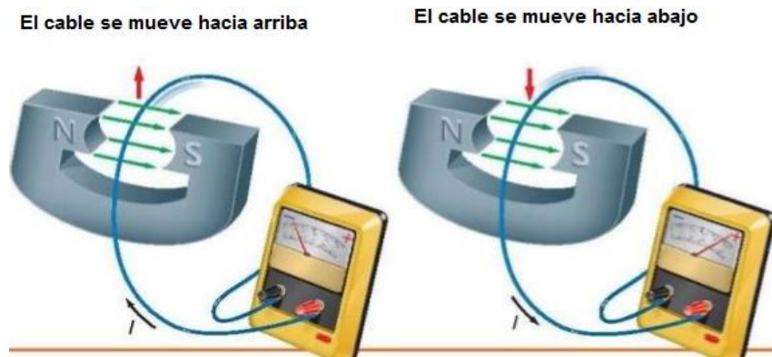
Figura 35. La dirección de la corriente inducida en un conductor que se mueve dentro de un campo magnético, depende de la dirección en que se mueve el conductor. Si no se mueve no hay corriente eléctrica.
