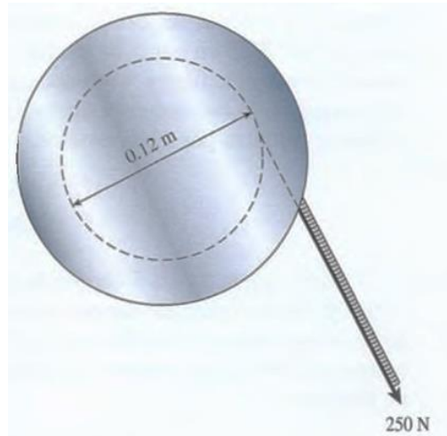
Fuerza tangencial ejercida por un cable enrollado alrededor de un tambor.
